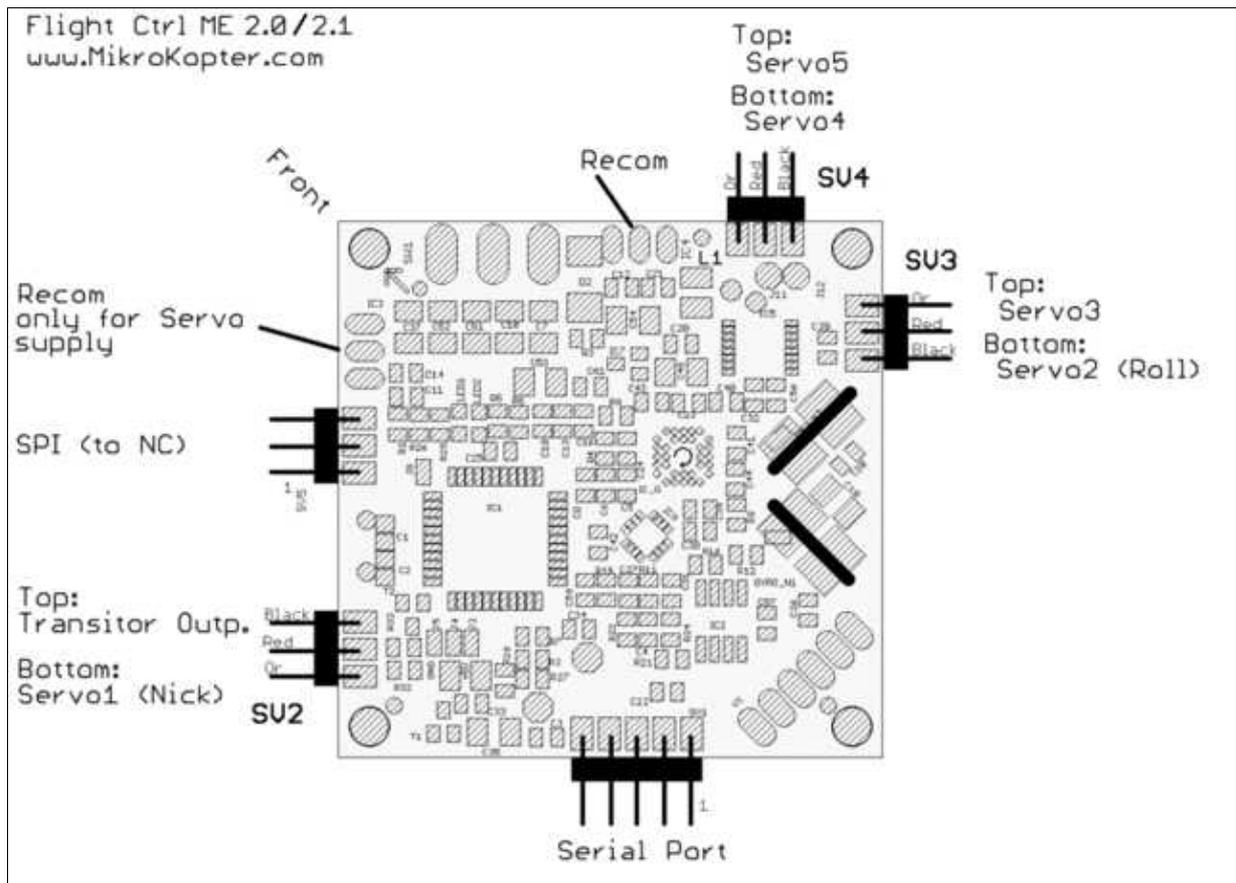
(bis auf die weiße Molex-Buchse ist die FC2.1 von den Steckanschlüssen identisch mit der FC2.0)
