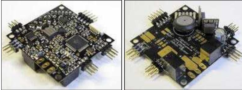
**i** Die FC V2.1 kann mit einem 5pol. Molex-Kabel an den Stromverteiler angeschlossen werden.
