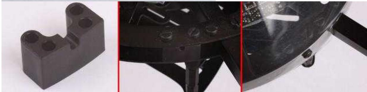
**⚠** Die Haube sollte von innen in einer beliebigen Farbe lackiert werden. Hierdurch werden Fehlfunktionen durch Sonnenstrahlen auf den lichtempfindlichen Höhengsensor verhindert.
