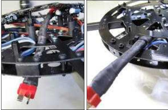
Nachdem das Powerboard mit den 8 Kunststoffschrauben (M3x8) an die acht Abstandhalter geschraubt wurde, kann mit dem Auflöten der Motorkabel begonnen werden. Das Ergebnis sieht so aus:
