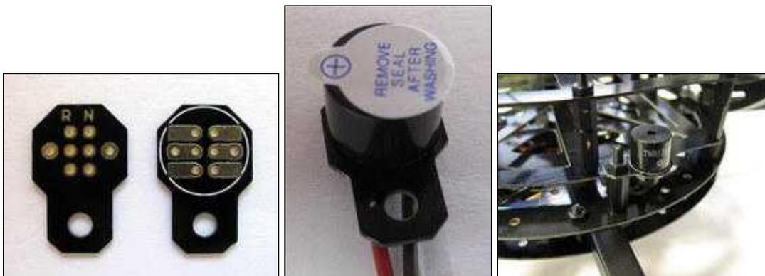
**i** Die Adapterplatine incl. Summer kann mit einem 15mm Abstandshalter an der Centerplate montiert werden. Der Halter sollte nicht am Lipo-Halter befestigt werden. Im Falle eines Crashes könnte das das Kabel zum Summer abreißen.
