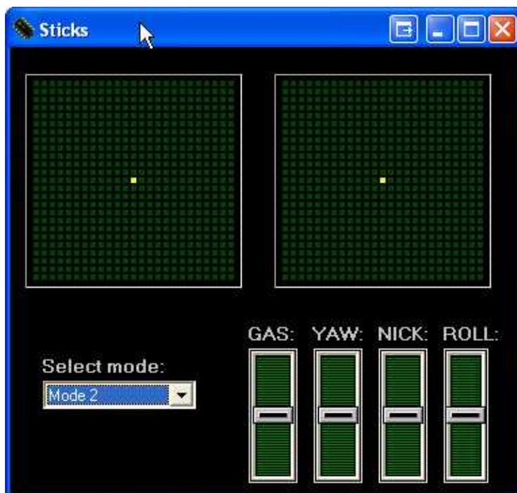
Mit dieser Anzeige kann die Funktion und die Stellung der beiden Steuerknüppel überprüft werden. Hierzu wird in dieser Anzeige der am Sender genutzte Mode (1-4) eingestellt. Werden nun die Steuerknüppel bewegt, sieht man die identischen Bewegungen und den Ausschlag in dieser Anzeige.
