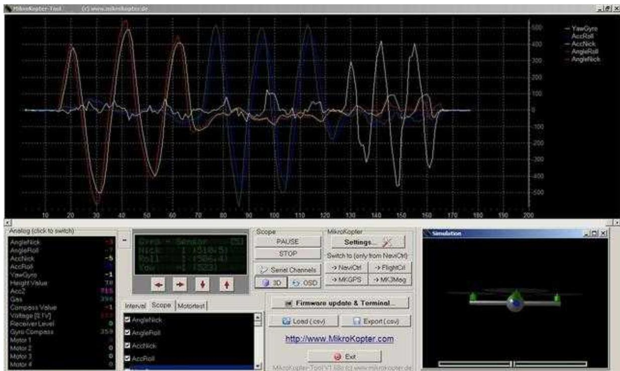
**Beispiel:** [FlightCtrl](#) Anzeige für Nick, Roll Gier. Um die Scopelinien zu bekommen, muss die [FlightCtrl](#) in die dementsprechender Richtung geneigt/gedreht werden!
